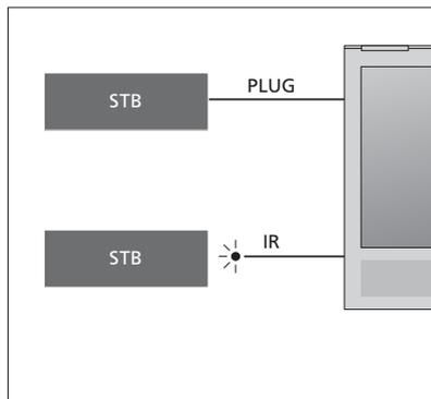
**红外线发射器：**在使用 Beo4/Beo6 遥控器操作非 Bang & Olufsen 产品时，应将 Bang & Olufsen 红外线发射器安装在非 Bang & Olufsen 产品上，然后将其与连接面板上标注为 PUC 的插孔之一连接。将发射器安装在所连接设备的红外线接收器附近，以确保遥控器操作。在安装之前，请确认您能够使用 Beo4/Beo6 遥控器操作电视屏幕上的设备菜单。
